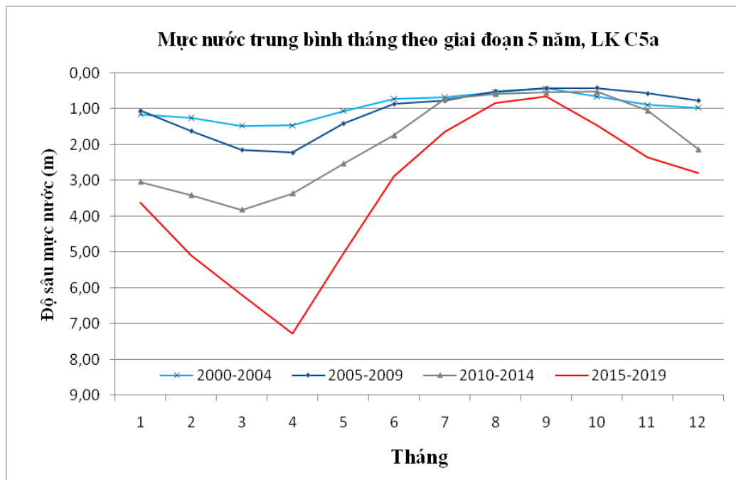
Hình 22. Dao động mực nước trung bình giai đoạn 5 năm tại lỗ khoan C5a
