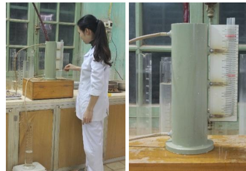
Hình 5.44 Thí nghiệm trong phòng xác định hệ số thấm của cát sỏi
