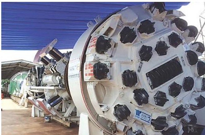
Thiết bị TBM 390E thi công 5km hầm DA Thủy điện Đa Nhim mở rộng-Lâm Đồng
