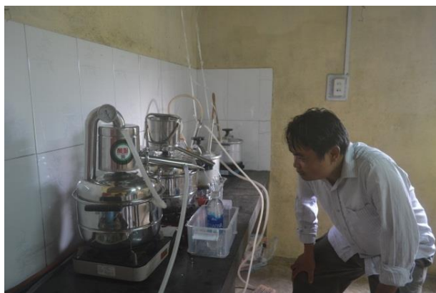
Hình 30. Chung cất mẫu tinh dầu tại thực địa, ảnh chụp tại VQG Bidoup – Núi Bà, 2017
