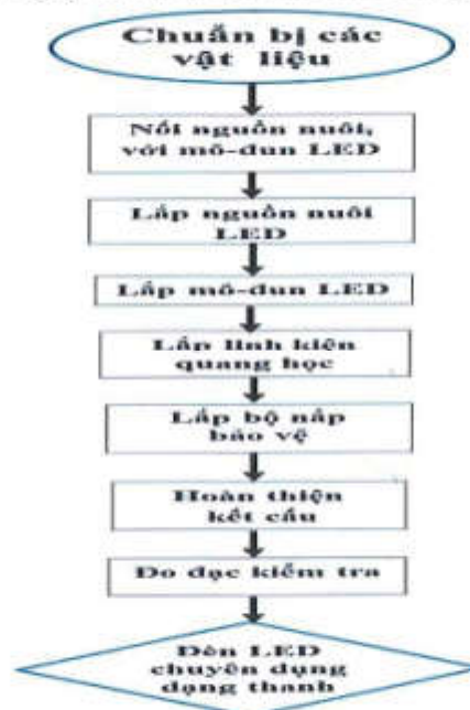
Hình 3.6. Sơ đồ quy trình sản xuất đèn LED chuyên dụng dạng thanh
