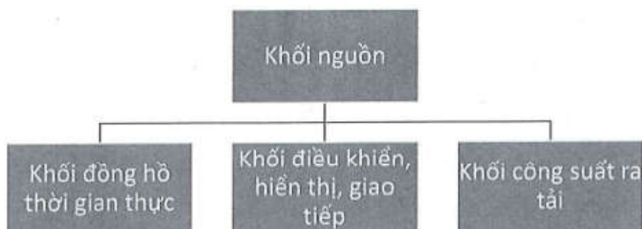
Hình 3.9. Sơ đồ khối bộ điều khiển thời gian đa kênh
