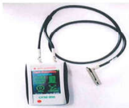
Hình 2.10. Máy đo hàm lượng diệp lục OPTI-SCIENCES CCM-300
