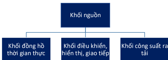
Hình 4.5. Sơ đồ khối bộ điều khiển thời gian đa kênh
