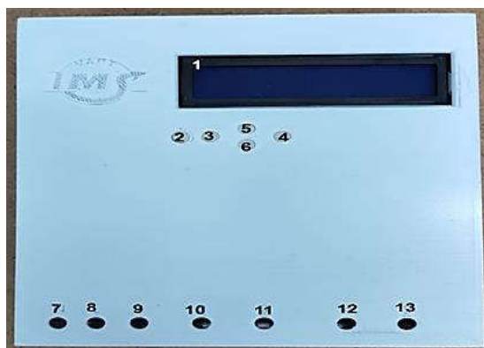
Hình 4.6. Bộ điều khiển thời gian đa kênh
