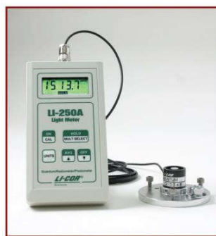
Hình 3.3. Máy đo độ rọi Lutro LX-107 (a) và máy đo bức xạ quang hợp (PAR) LICO-LI-250 a (b)
