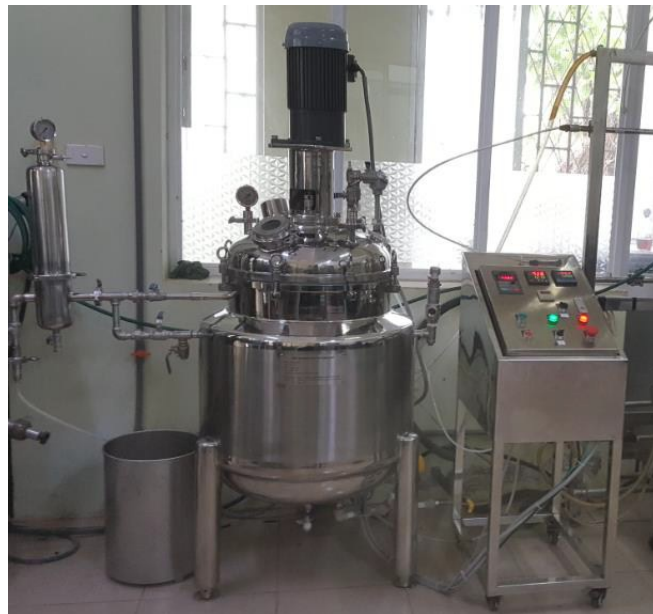
Hình 51. Thiết bị nhân nuôi sinh khối được trang bị bằng kính phí của đề tài TN18/C11 [30]
