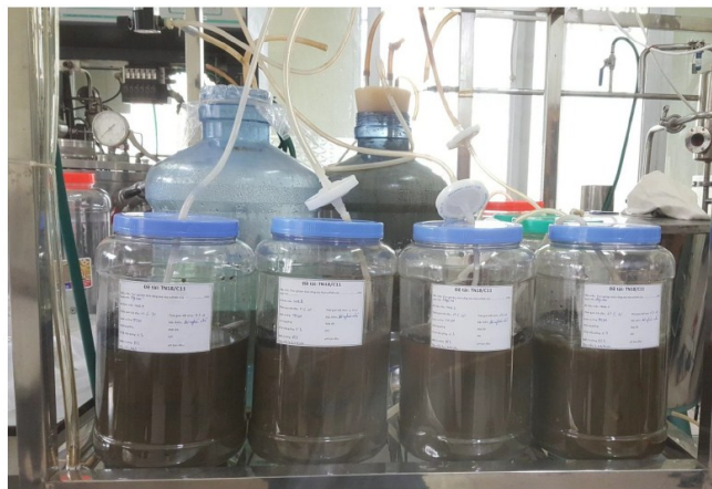
Hình 52. Thiết kế thí nghiệm xử lý quặng tinh sulfide - Au ở quy mô 5 kg/mẻ [30]
